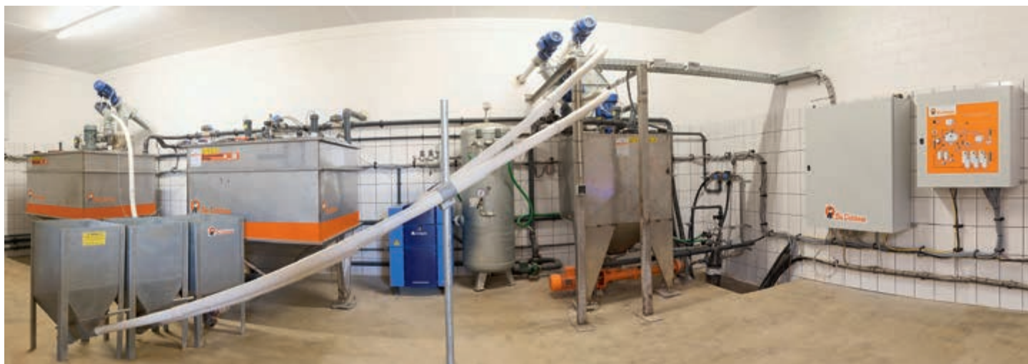
Kig ind i en foderlade med trykluftbaseret HydroMix-vådfodring til smågrisestalden og et 1-tank anlæg til sostalden
