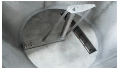
Beholderbund med Z-formet-omrører og udtræksneglen
